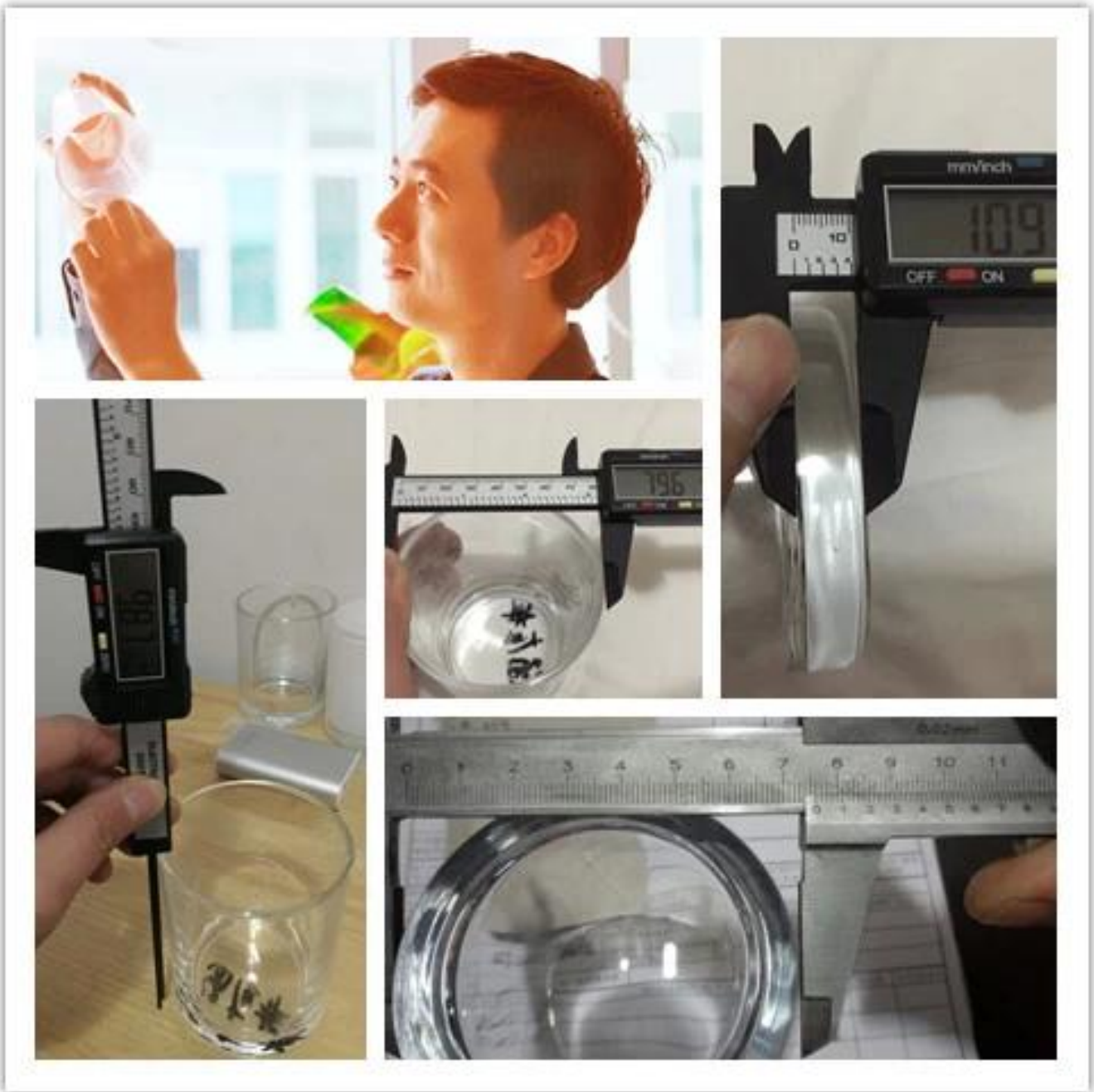
Sunny Glassware 1992 年 1 月 1 日 起 實 施 的 新 標 準 中 規 定 了 各 種 規 格 玻 璃 杯 的 口 徑 誤 差 限 值 為 0.24mm。本 廠 為 了 保 證 產 品 質 量 符 合 標 準 要 求 ， 特 採 取 嚴 格 的 質 量 控 制 措 施 ， 實 施 全 面 的 質 量 管 理 體 系 ， 確 保 每 一 個 出 廠 的 玻 璃 杯 均 能 滿 足 標 準 要 求 。
